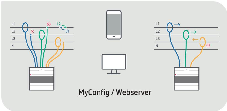
Modifica la posición de las tensiones y corrientes para evitar errores de lectura de potencias, energías, factor de potencia y cos fi.
