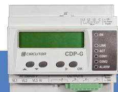
Les contrôleurs **CDP** (Dynamic Power Control), ajustent à tout moment la puissance de production maximale des inverseurs photovoltaïques à la puissance consommée dans le bâtiment. De cette manière, il est possible d'assurer, par exemple, la non-injection de surplus d'énergie dans le réseau, ou l'injection de la fraction de puissance autorisée par la législation de chaque pays. Certificat selon la norme **UNE-EN 217001**.
